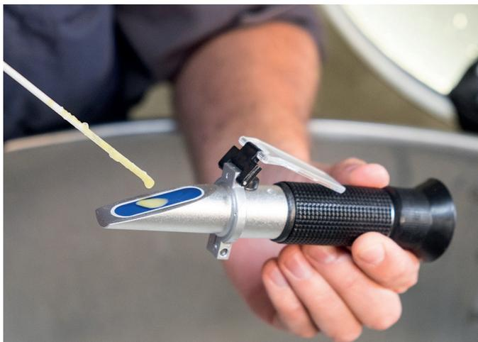
L'avantage du réfractomètre est qu'il mesure de façon très précise et que la température ne joue aucun rôle.
